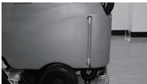
清水箱水位透明管
