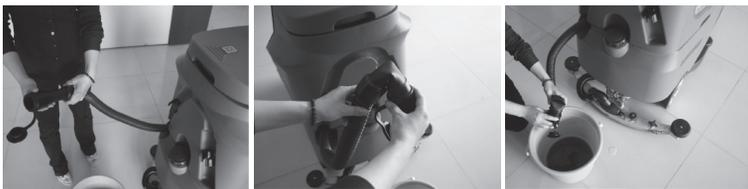
4. 箱内污水排尽后，将污水箱盖抬起，使用清水冲洗污水箱内部。
