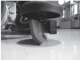
2. 如果吸水扒胶条与地面非接触或有一点缝隙，请调整箭头“3”所示的2只调整螺母，顺时针旋转吸水扒螺母，使吸水扒胶条上升；逆时针旋转此旋钮，吸水扒下降，与地面接触，最佳状态请根据实际需求进行调整。
