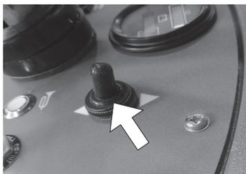
说明 2：机器前进与后退开关打在“后退”方向，要用吸水扒升降摇臂抬起吸水扒，吸水马达自动关闭，同时用刷盘升降摇臂抬起刷盘，手动倒车灯亮起，以表警示。
