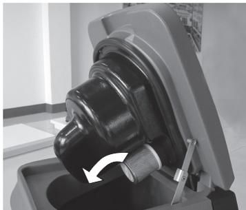
5. 用清水冲洗污水箱内部的污水感应罩。
